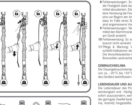
Fehleranwendungen: Scharfe Kanten, Grate und Abkantungen können die Festigkeit stark beeinträchtigen, ggf. sind diese durch geeignete Hilfslinien zu verhindern. Bei einer Verwendung der Edelrid Sicherheitsleiter ist ein Verlust des Sicherheitsmaßes zu erwarten.
